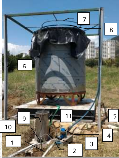
Şekil 4. Lizimetre, sulama sistemi ve tahliye tankı (Su şebeke borusu (1), küresel vana (2), selenoid vana (3), dijital su sayacı (4), hortum (5), iskele (6), dairesel demir (7), damlatıcılar (8), tahliye tankı (9), motopomp (10), basınç sensörü (11))
